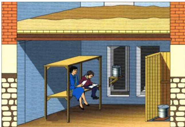
Рис. 4 — Подвал, приспособленный под укрытие
